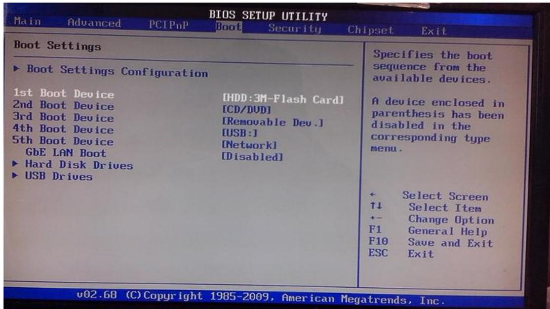
6、按下回车，出现引导启动设备，用光标移动白亮条在 USB 上，按“Enter”确定。USB 设备在第一项。
